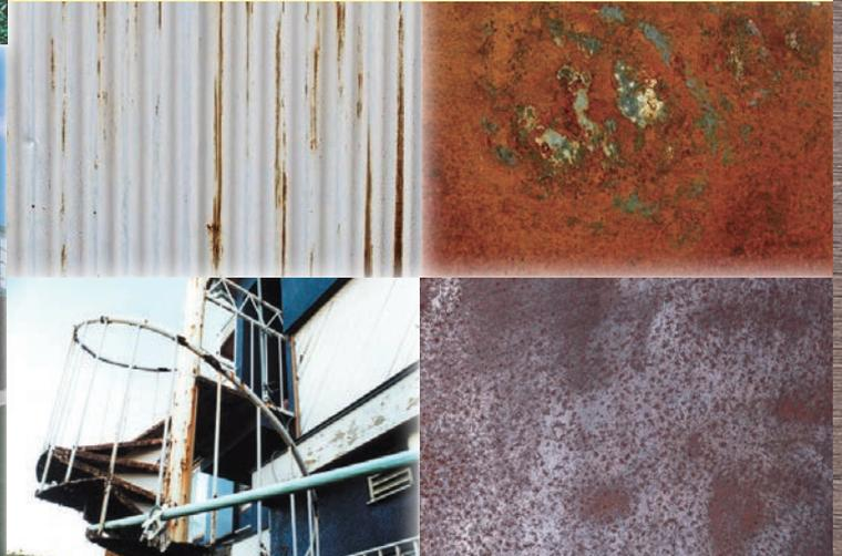
鉄部の改修における素地調整は、改装後の素地・塗膜の耐久性に大きな影響を与えます。さびを十分に除去すれば、それだけ素地・塗膜の耐久性は向上します。しかし実際の施工現場では、作業環境や作業部位によってさびの除去度合いに差が生じてしまい、さびを完全に除去するのは困難であるのが実情です。そこでケレン後の除去しきれない残存さびを安定化させ、その上に塗装される塗料の保護効果を最大限に引き出すために開発されたのが、さび面浸透形プライマー「サビフィックス」です。
