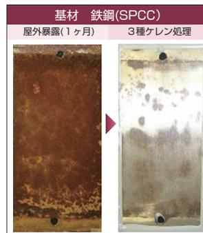
※著しく劣化(さび発生)させ、その後ケレン処理したものを基材とする。
