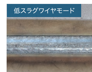
溶接欠陥のないきれいなビード
