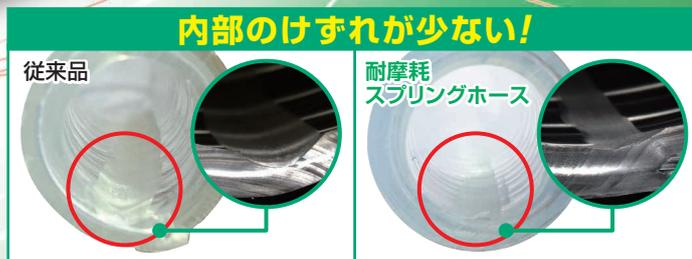
試験方法: ヤスリ(上目58)を1秒=1回の速度で前後1000回、75mm移動させて試料ホース内面を摩耗させる。
