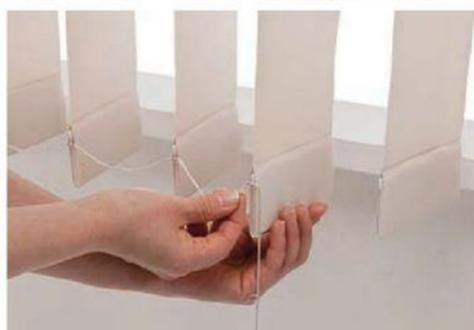
ヘッドレールのキャリアにルーバーを掛けていきます。そのとき、ルーバーの向き(角度)はルーバーの上部の縫いしろを一定方向にそろえて掛けてください。
