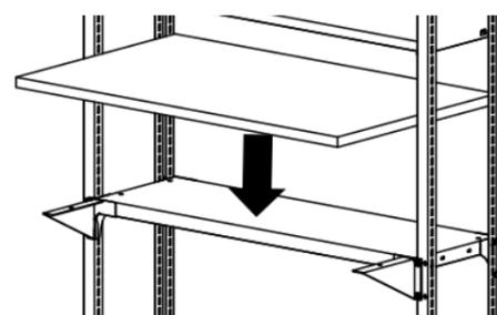
POINT 棚の水平を確認後に本締め(十分に締め付け)します。
