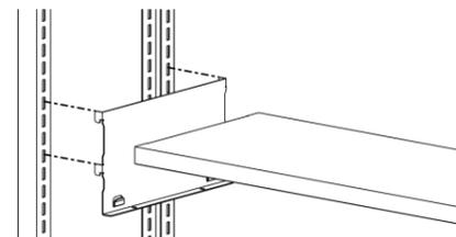
POINT 左右の棚受の高さがずれると、棚板変形・落下の危険性があります。支柱孔を数えながら棚受を設置すると、スムーズに取り付けできます。
