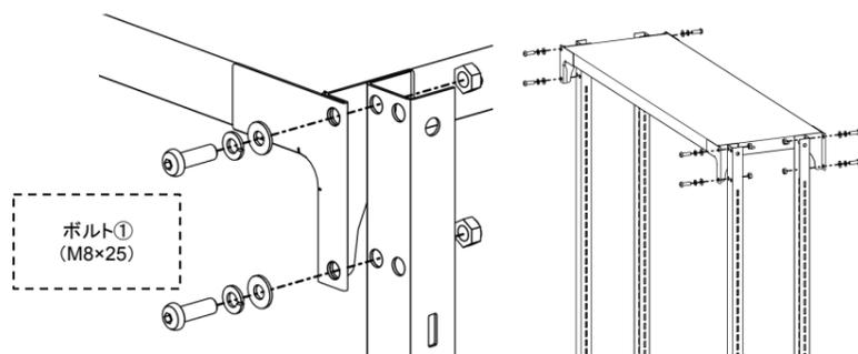
POINT 支柱・天板は、ボルト・ナットで仮止め(軽く締め付け)しておきます。
