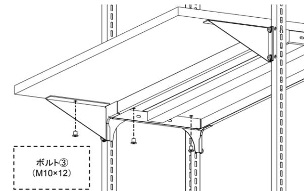
7 支柱孔に棚受を取り付け、その上に棚板を載せてください。
