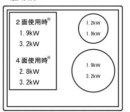
数字上:火力レベル9 (最大)の消費電力 数字下:パワーブースト使用時の消費電力
