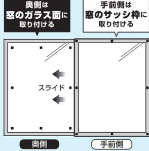
①「面ファスナー カット目安」を使って面ファスナーをカットする。カットした面ファスナーAの粘着面を下図を参考に8カ所取り付け(※)、幅と高さを測る。
