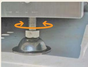
水平器を使って、前後左右の水平を出します。
