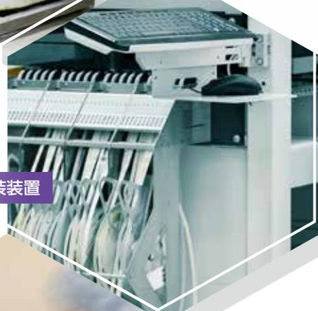
電子部品の実装装置
