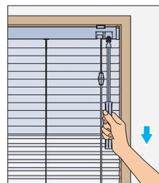
グリップの引き方を調整することで、下部のスラットの角度が調整できます。
