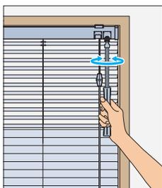
グリップを左右に回転させると、上部のスラットの角度が調整できます。
