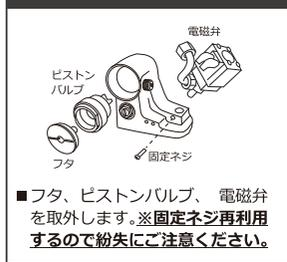
電磁弁ユニット、止水ナット、止水パーツを取付け止水する。
