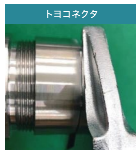
工具が真横からしか入らず、狭所で取り付けしづらい
