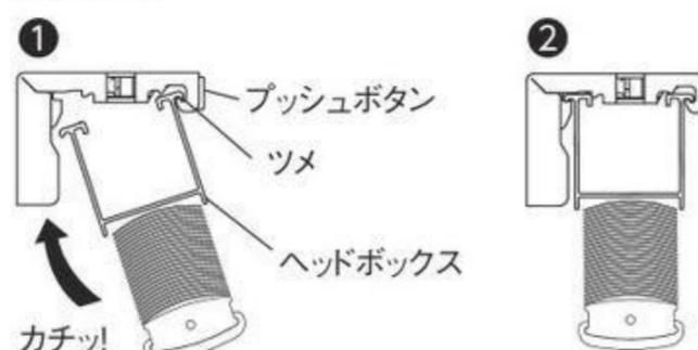
ヘッドボックス手前のツメをブラケット手前のツメに引っ掛けて左右の取付け位置を決めてください。その後、図のように「カチッ」と音がするまで押し込み、固定してください。
