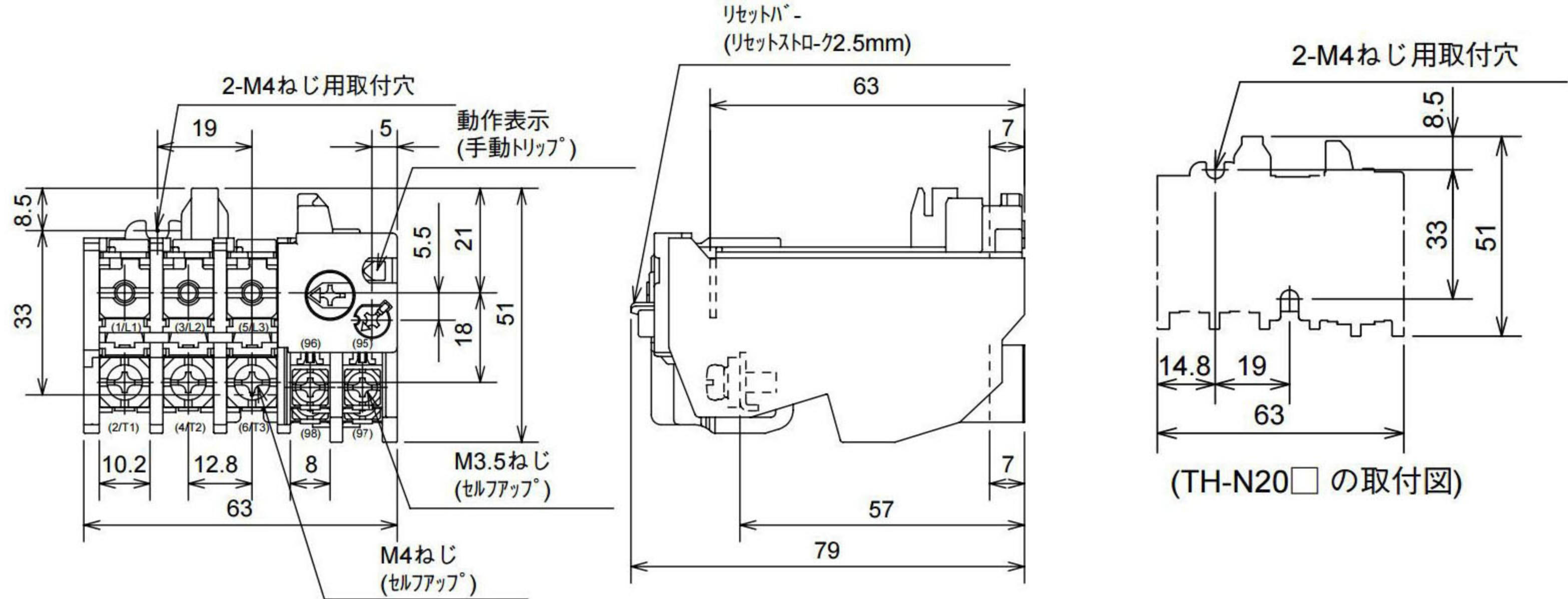
電源側端子ねじは製品に添付 (TH-N20、TH-N20KPのみ)、TH-N20CX、TH-N20CXKPの時はUN-TH21CX、UN-TH25CXと組合わせて使用されますので、電源側端子ねじは添付していません
