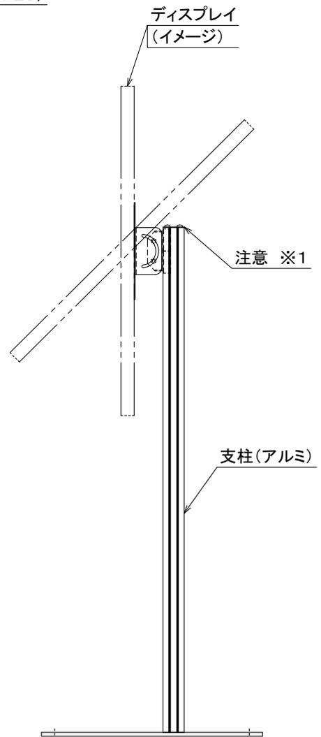
※1 ディスプレイ設置高さ最大時 傾斜角度  $-10^{\circ} \sim 45^{\circ}$
