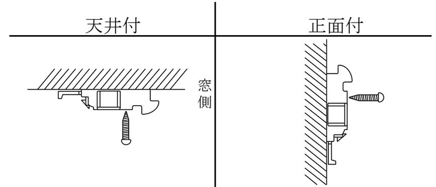
フレームが水平になるよう注意してブラケットの位置を決め、付属の取付用ネジで確実に取り付けて下さい。
