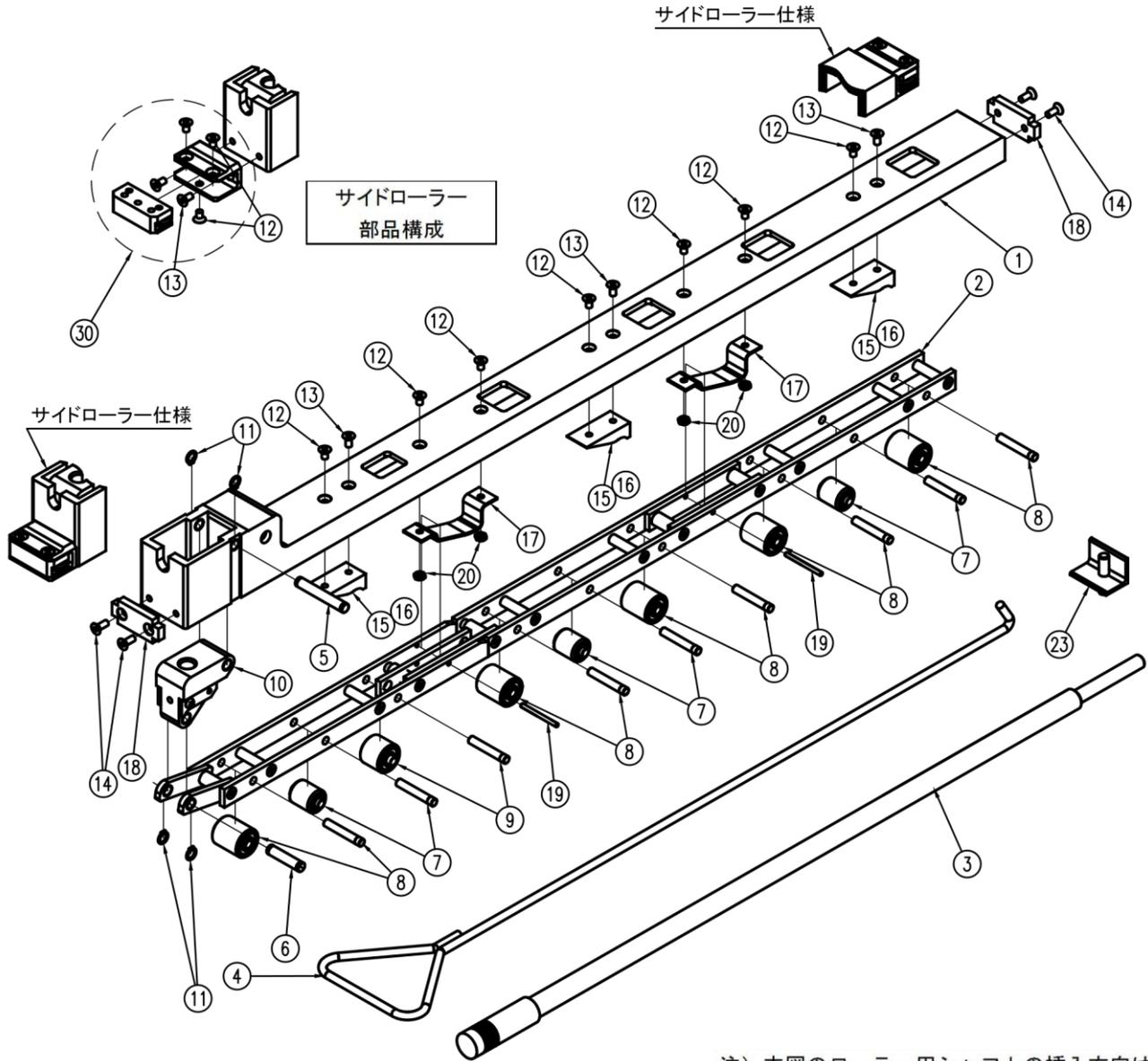
注) 本図のローラー用シャフトの挿入方向は、ローラー交換時の挿入方向を示します。
