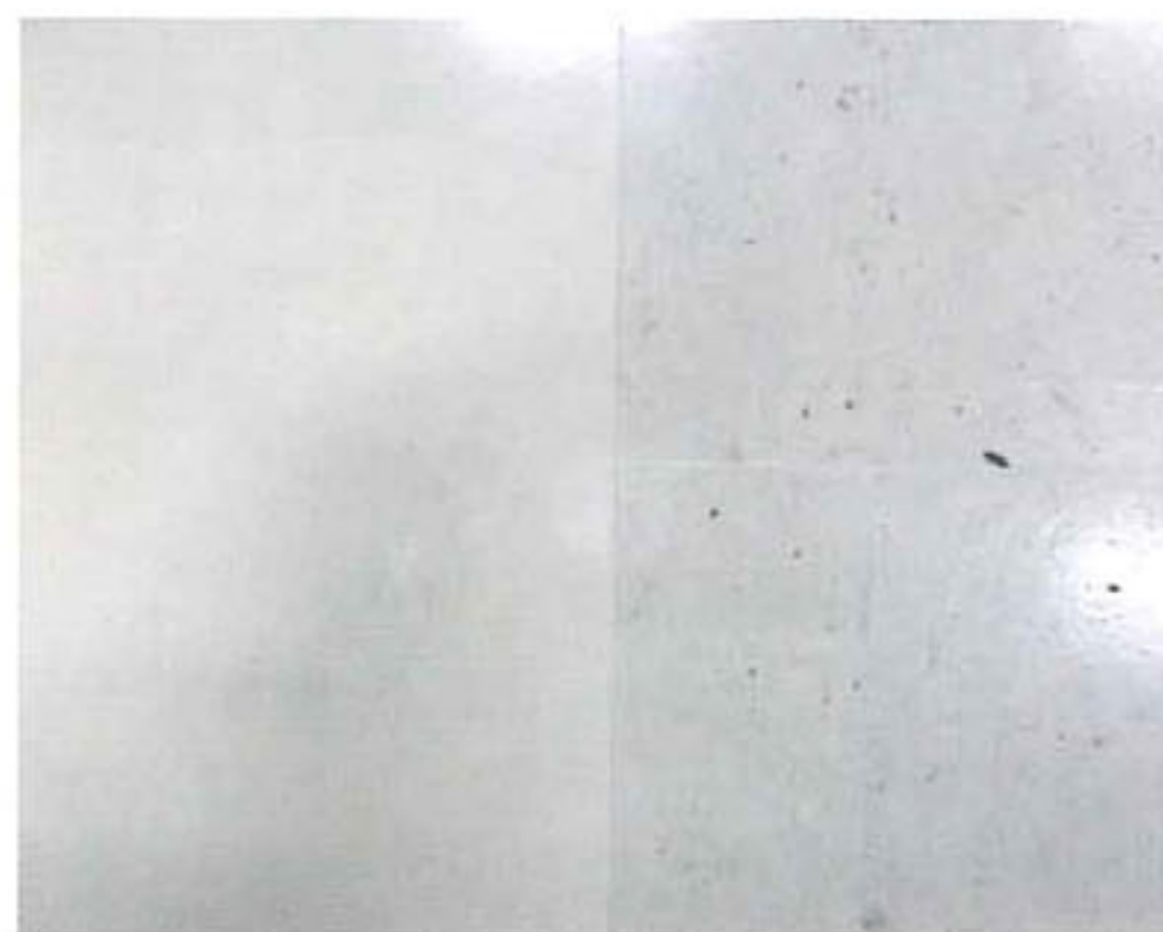
フロアトップアキュアW#5000 (左:耐汚染試験前 右:試験後2ヶ月)
