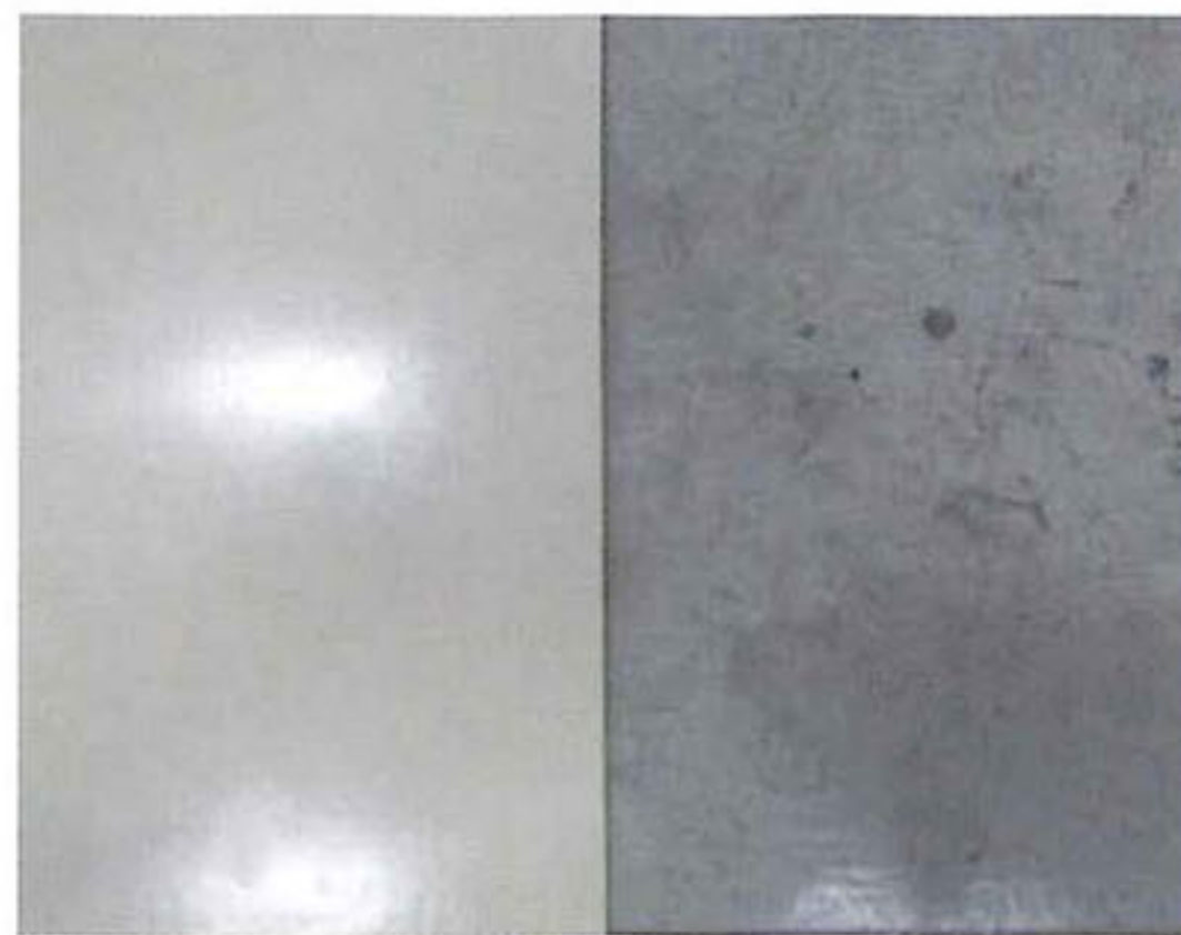
水性アクリル (左:耐汚染試験前 右:試験後2ヶ月)
