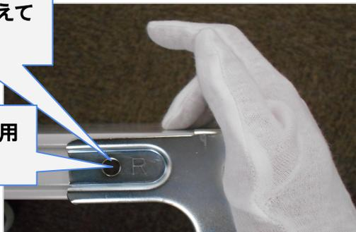
棚板の四隅にガセットプレートを差し込み、ボルトナットで固定。
