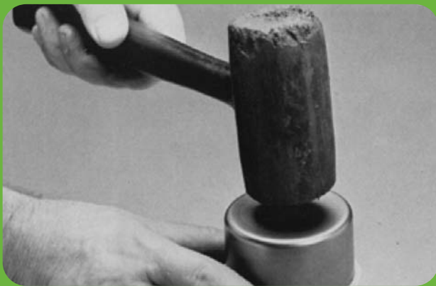
⑦ 組込み治具をハンマで叩き、スリーブをシャフトに打ち込みます。
