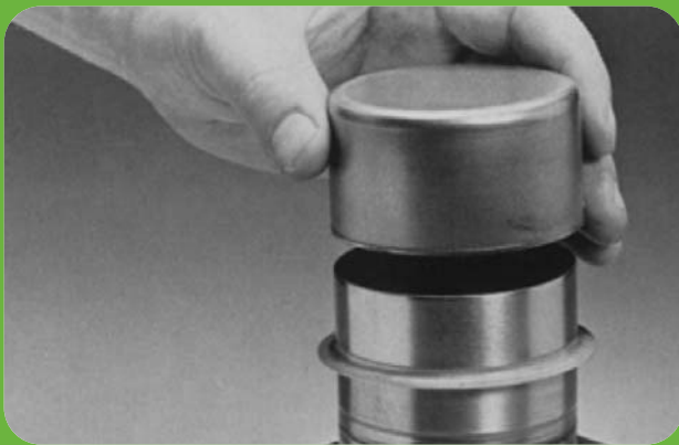
⑥ 組込み治具をスピーディ・スリーブにかぶせます。
