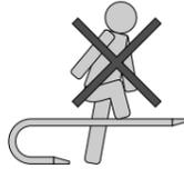
2. プラレールチェーンの連結、切り離し、開閉、保守点検等の際にはプラレールチェーンが動かないようにしてください。自重により自走したり、倒れたりして負傷する危険があります。
