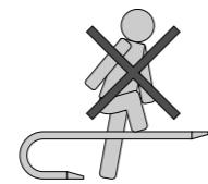
2. プラレールチェーンの連結、切り離し、開閉、保守点検等の際にはプラレールチェーンが動かないようにしてください。自重により自走したり、倒れたりして負傷する危険性があります。
