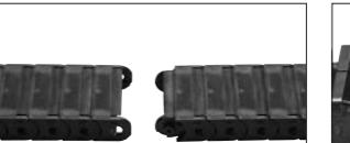
リンクの方向を揃えて両側から押し込むと連結されます。
