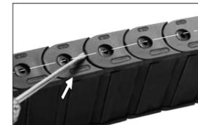
中心線より外周面側(R刻印側写真位置)のリンク隙間に差し込んだマイナスドライバーを起こすと外れます。
