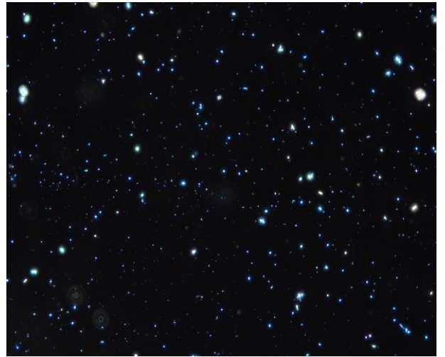
顕微鏡写真-2 (アモサイト用) 屈折率: 1.680 アモサイトの分散色: 桃色
