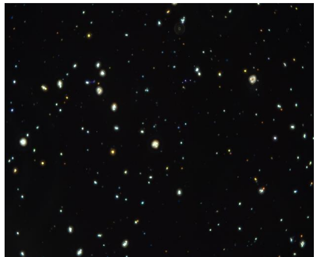
顕微鏡写真-4 (アンソフィライト用) 屈折率: 1.618 アンソフィライトの分散色: 橙～赤紫色
