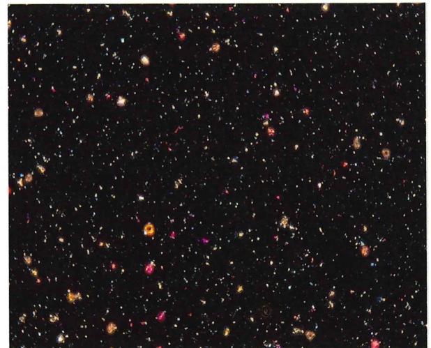
顕微鏡写真-6 (アクチノライト用) 屈折率: 1.628 アクチノライトの分散色: 赤紫～桃色
