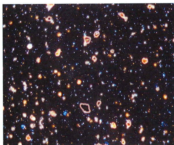
顕微鏡写真-5 (トレモライト用) 屈折率：1.620 トレモライトの分散色：赤紫色
