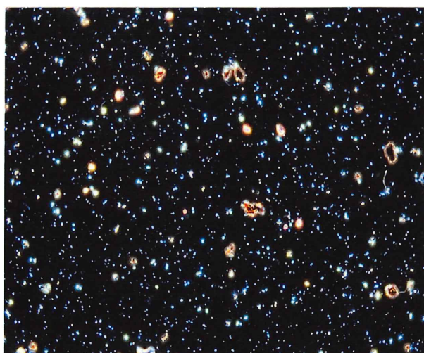
顕微鏡写真-3 (クロシドライト用) 屈折率: 1.690 クロシドライトの分散色: 桃色
