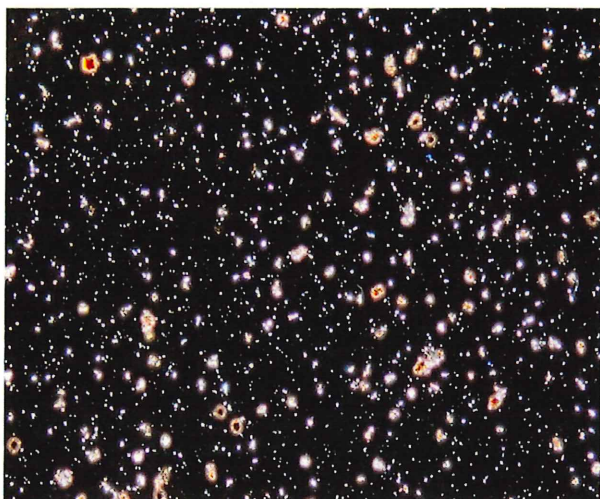
顕微鏡写真-1 (クリソタイル用) 屈折率: 1.550 クリソタイルの分散色: 赤紫～青色
