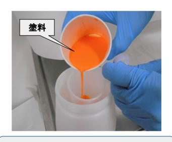
簡易粘度計を使い、塗料粘度を測ります。 ※塗料は、必ず塗料メーカーで指定された溶剤で 希釈してください。
