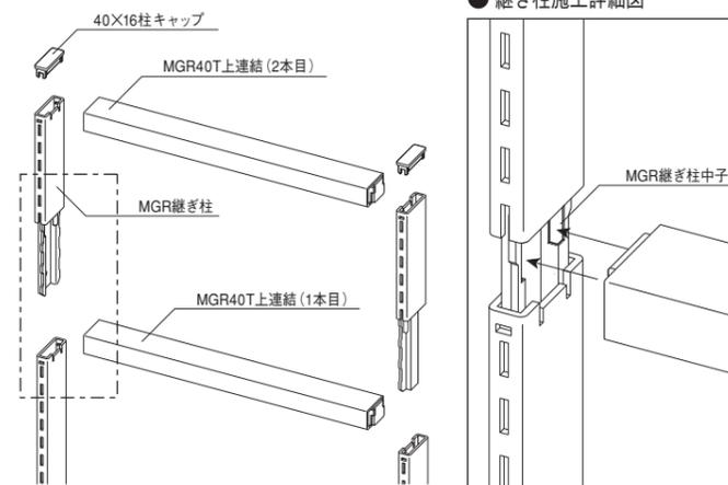
**2.** MGR棚板にCMRブラケットを取り付けて、MGR棚板を組み立てます。その後、継ぎ柱スリットの任意位置に取り付けて完成です。
