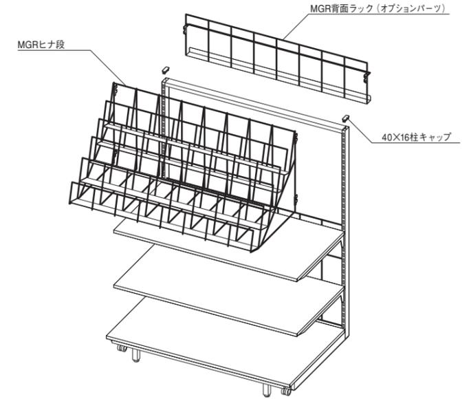
**5.** MGRヒナ段こぼれ止めをヒナ段の雑誌背もたれの内側に通し、柱のスリットに引掛けます。その後ヒナ段前部の雑誌受けにある孔にこぼれ止め前部を差し込みます。
