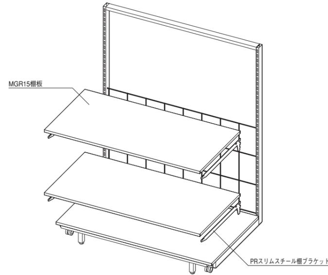
**4.** MGRヒナ段を前面スリットの最上部に、MGR背面ラックを後面スリットの任意の位置へ引掛けます。その後柱キャップを左右の柱頭頂部に打ち込みます。
