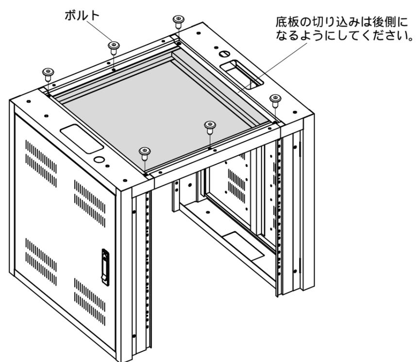
注：ボルトは最初はすべて緩めに締めおきゆがみなどを確認後に締め直してください。
