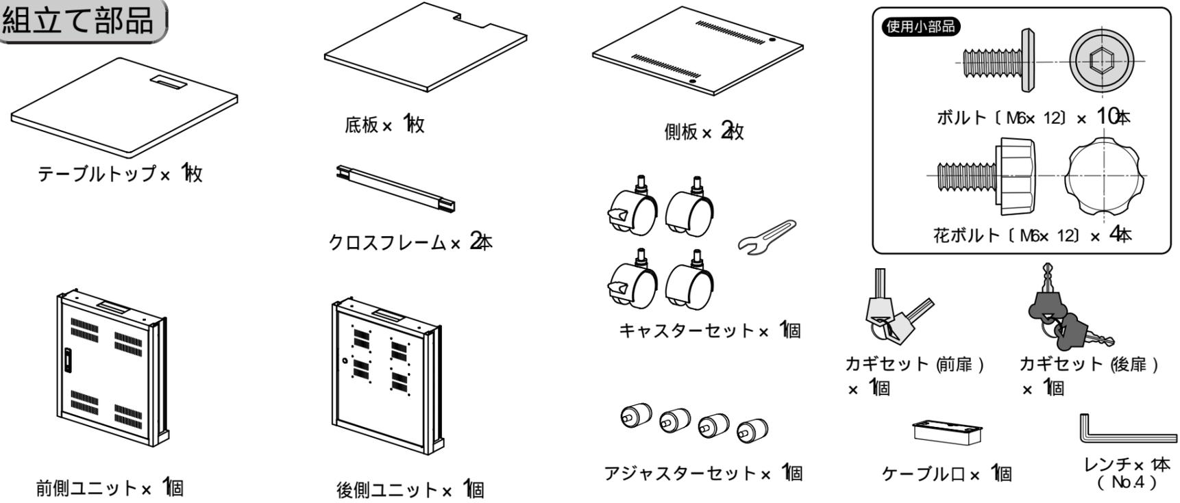
1 前側、後側ユニットにクロスフレームを差し込みます。
