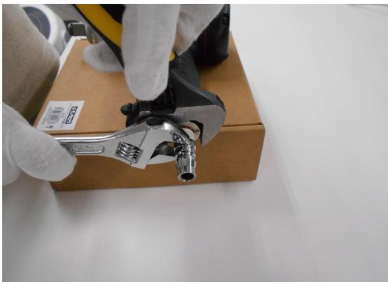
カップラー取付の際は本体のナットが空回りするため共掛けで締めます。台の上で作業すると楽です。
