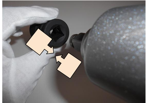
ソケットの角形状とCリングの位置を合わせて強く押し込みます。
