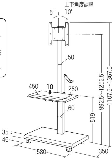
総耐荷重 25kg (15kg以下のテレビを取付け可能)
