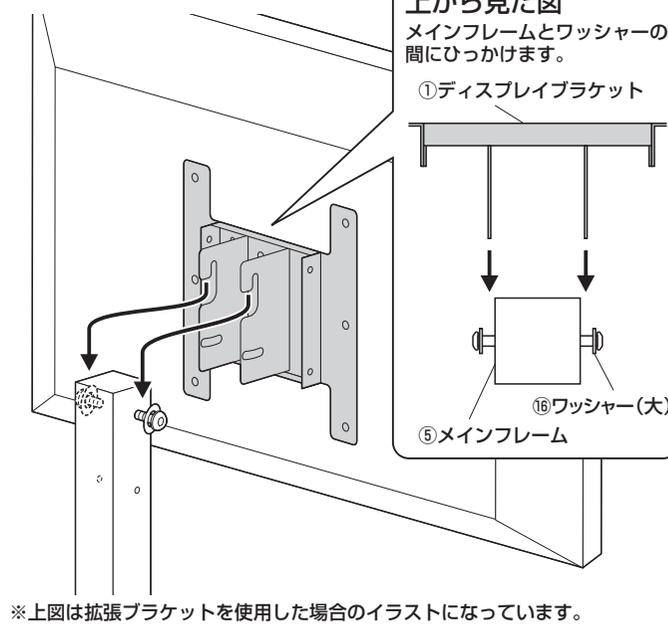
③ボルトAを締付けて固定します。
