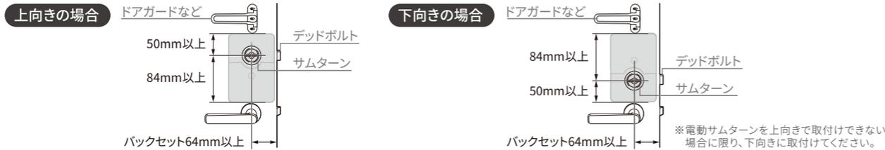
2 玄関ドアの吊元側内観に①②③いずれかのコントローラー取付けスペースが確保できることを確認してください。
