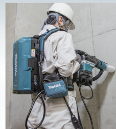
充電式ハンマドリル・HR400DN 1充電作業量 ※3 (コンクリート圧縮強度40MPa φ18mm 深さ140mm) 約60本
