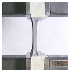
サイディングボードとの引張接着試験
