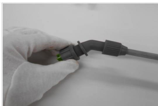
ノズルパイプの先端に取り付けます。
