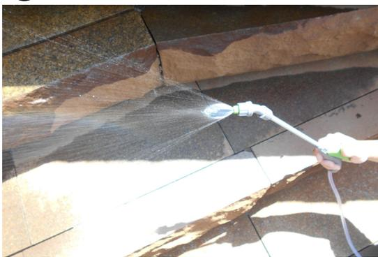
付属の拡散先端ノズルに取り換える
