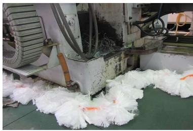
機械設備の漏油回収
