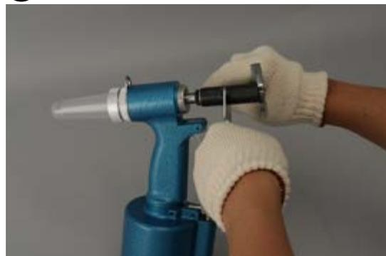
【2】のジョーケースヘッド部分を反時計方向へ回します。
