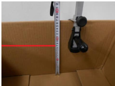
ダンボールの縁から100mm下に折り目を付ける為、本体スケール100mmの位置にガイドを固定。
