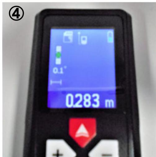
④ レーザーが消え、液晶ディスプレイに測定結果が表示されます。
