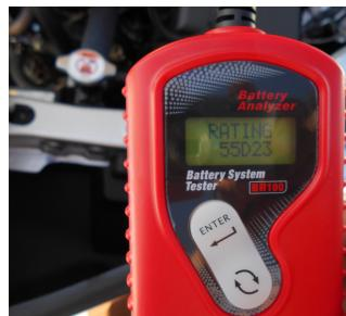
測定するバッテリーが「55D23」より小さい場合、又は大きい場合はセレクトキーを長押しし、液晶表示画面に「↓」が点滅表示されますので、セレクトキーを押して測定するバッテリーを選定して下さい。
