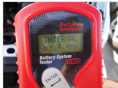
極板の劣化状態を測定します。
