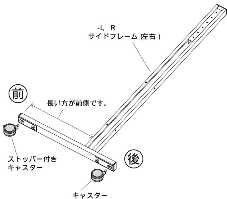
2 サイドフレームにバックフレームをボルトで取付けます。
