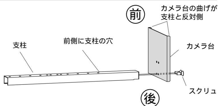
8 モニターフレームに支柱をボルトで取付けて完成です。
