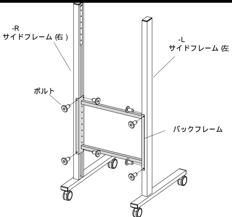
3 サイドフレームにモニターフレームをボルトで取付けます。
