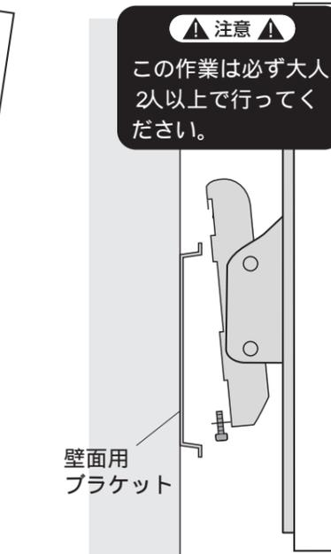
(3) ディスプレイ用ブラケットのボルトを締めます。
