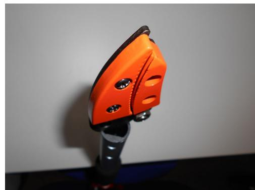
刃の軸と柄部を固定している部品
