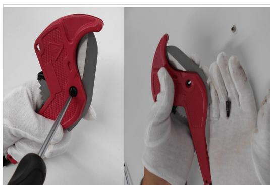
刃を止めているプラスねじをドライバーを使用して外します。
