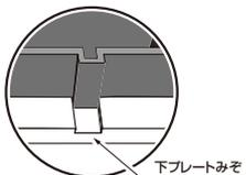
2. ボール栓穴開け工具のプレートをおろして、穴開けピンがインクタンクのQRコード中央の位置に当たっていることを確認します。
