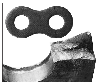
② 疲労による破断
