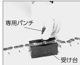
図7. プラコンビチェーンの分解
