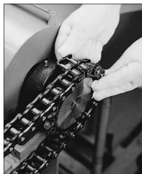
図8. スプロケット部で継ぐ
