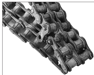
図34. ステンレスローラチェーンの腐食
