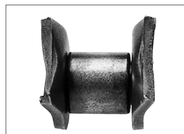
③ オフセットプレートの疲労による破断
