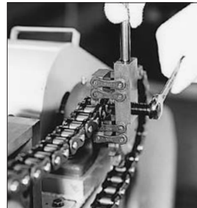
図5. チェーンスクリュによる切り方
