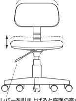
・レバーを引き上げると座面の高さ 調節ができます。
