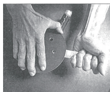
⑥ナットを固定したまま、新しいパッドを時計回りに回し、本体に確実に取付けてください。
