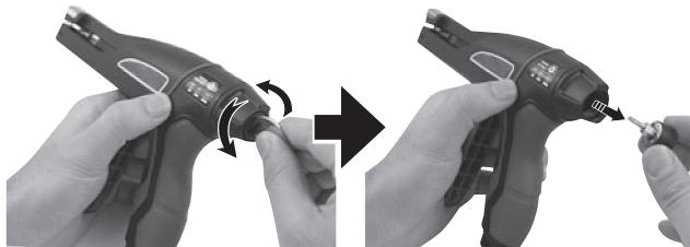
② ドライバーで口金用ネジを回し、口金を取り外す
