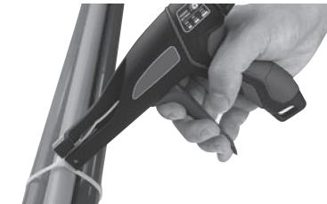
④ トリガーを引いてケーブルタイを締め付け、余りを切断する
