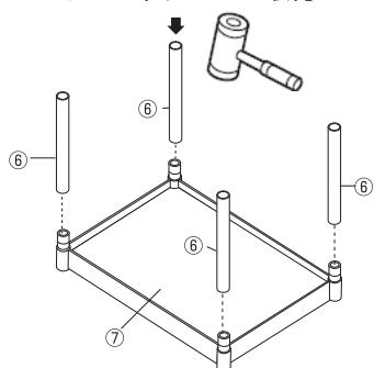
2 ゴムハンマーなどを使用してパイプを中トレーに取付ける。
