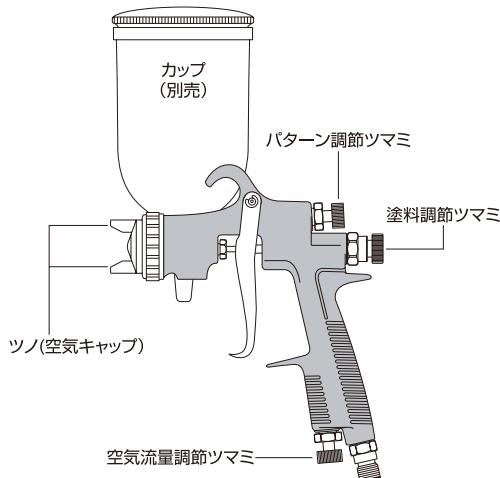
①塗料調節ツマミを回して塗料量を調節します。
