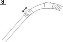
吸込量調整部を上下させると吸込み
